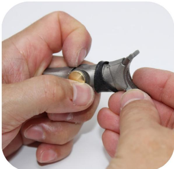
**4.** Utilizzare lo strumento di installazione per posizionare la fascia dell'impugnatura nell'apertura della fascia dell'impugnatura.
