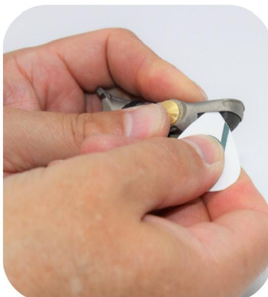
**3.** Premendo i bordi, applicare pressione sulla parte superiore del cuscinetto e oscillare delicatamente avanti e indietro per assicurarsi che sia in posizione. Se sembra che il cuscinetto sporga ancora, ripetere il passaggio 2.
