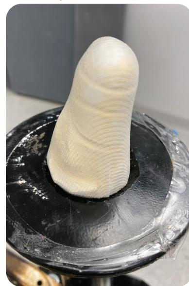
4. Coloque a fibra de carbono sobre a camada de PVA.
