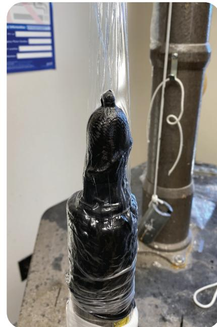
7. Misture a resina e despeje-a sobre o modelo pelo saco de PVA. Saturar a fibra de carbono com a resina e alisar quaisquer rugas sobre o saco de PVA.
