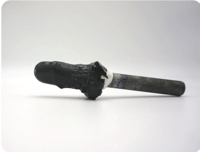
Arreglo de Capas inicial fijado a un mandril
