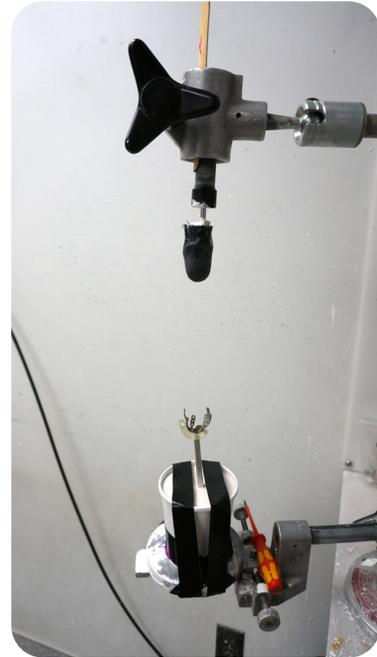
3. Bajar el arreglo de capas inicial hasta que esté en contacto con el soporte.
