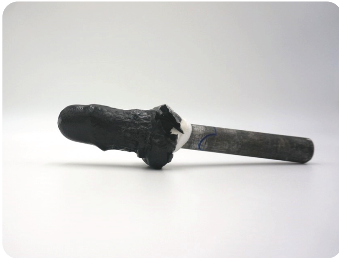
Eerste lay-up bevestigd aan een doorn
