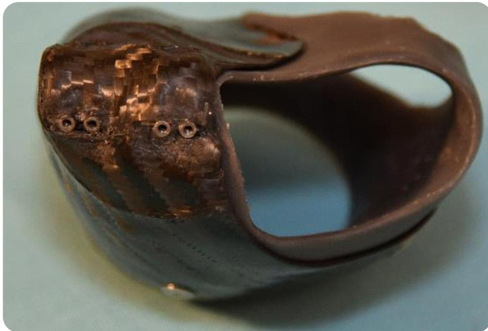
17. Una vez que se haya completado el curado y el modelo se haya enfriado, limpie el pre-impregnado y retire los espaciadores de laminación.
