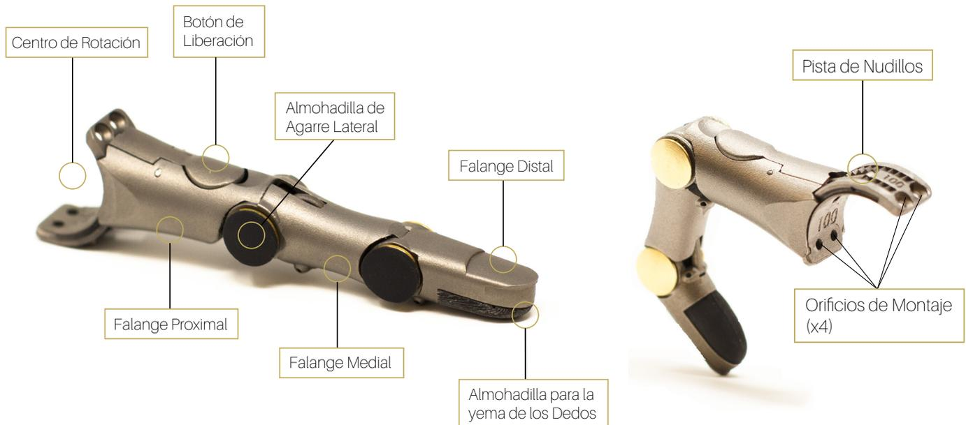
**Point Digit** viene ensamblado como una sola unidad. **Point Digit** se compone de un nudillo curvo, una falange proximal, una falange medial, una falange distal, un botón de liberación, almohadillas para las yemas de los dedos, almohadillas de agarre laterales y varias otras partes internas. La pista de nudillos curvos tiene 4 orificios de montaje.
